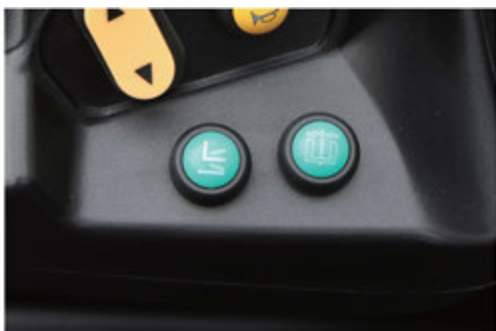
Poziomowanie i centrowanie wideł jednym kliknięciem.
