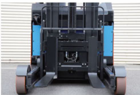
Wbudowane urządzenie do przesuwu boczego.
