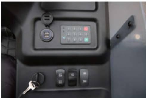
Wielofunkcyjna blokada hasłem i przełączanie w czasie rzeczywistym między trybami sterowania 180°/360°.
