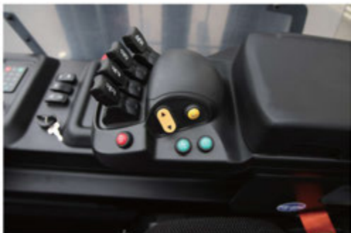
Scentralizowana konsola sterująca obsługiwana za pomocą palców.
