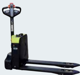
Wózek paletowy unoszący 1800 kg
