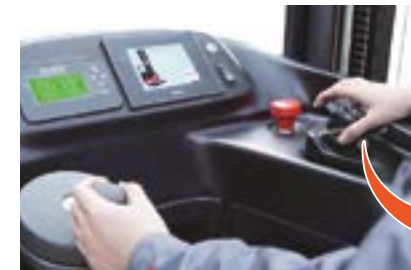
Centralnie położony panel sterowania z obsługą dotykową - wygodną i dokładną.
