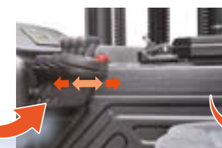
Kierownicę i centralną konsolę sterowniczą można swobodnie regulować w każdym kierunku, dostosowując je do wygodnej obsługi.
