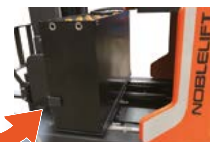
Aby wymienić akumulator, należy pociągnąć tacę do przodu. Mechanizm zwalniający tacę akumulatora znajduje się w pobliżu stopy operatora.
