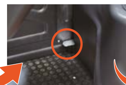
Aby wymienić akumulator, należy pociągnąć tacę do przodu. Mechanizm zwalniający tacę akumulatora znajduje się w pobliżu stopy operatora.
