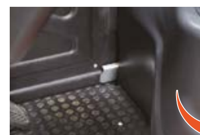
Aby wymienić akumulator, należy pociągnąć tacę do przodu. Mechanizm zwalniający tacę akumulatora znajduje się w pobliżu stopy operatora.
