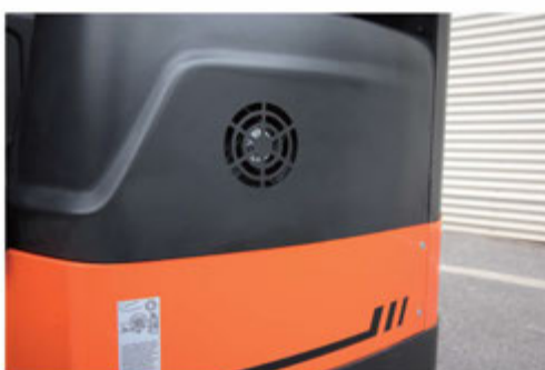
Układ chłodzenia silnika.
