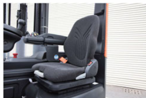
Fotel zawieszonowy z wysoką elastycznością i amortyzacją wstrząsów.
