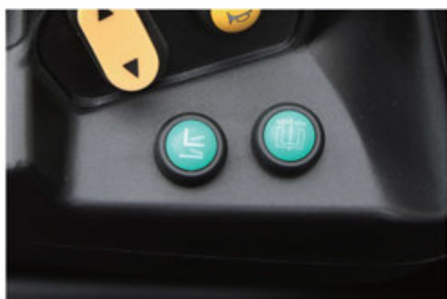
Poziomowanie i centrowanie widet jednym kliknięciem.
