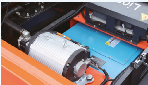
Otwarta konstrukcja dostępu sterownika i silnika podnoszącego - wygodniejsza konserwacja.
