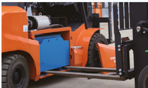
Konstrukcja z bocznym otworem na akumulator litowy - wygodna i szybka wymiana.
