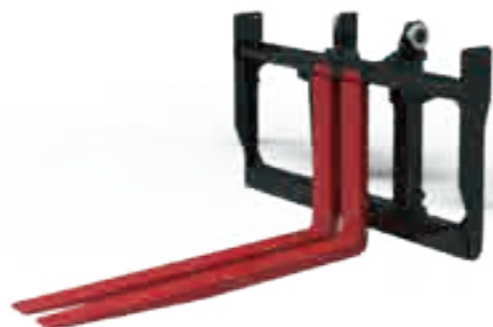
KARETKA TYPU HAKOWEGO QD Z DWUFUNKCYJNYM PRZESUWEM BOCZNYM Z RÓWNOCZESNYM I NIEZALEŻNYM POZYCJONOWANIEM WIDEŁ
