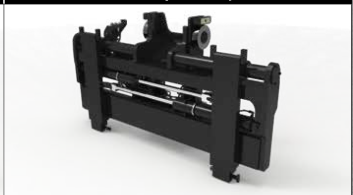
Dwufunkcyjna karetko typu hakowego z 2 dodatkowymi funkcjami
