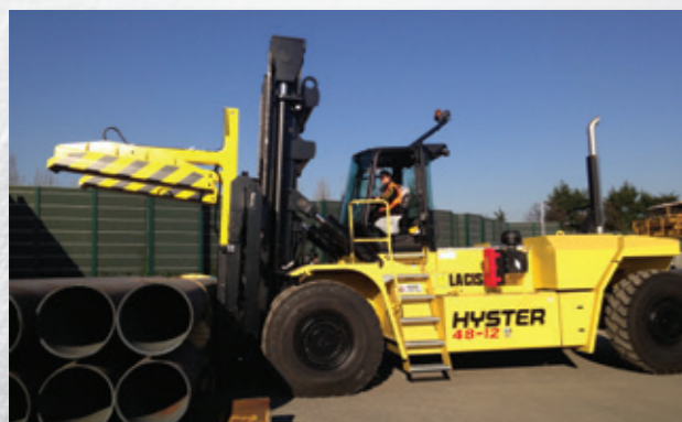
Wózek 48T ze stabilizatorem – do transportu bliskiego rur
