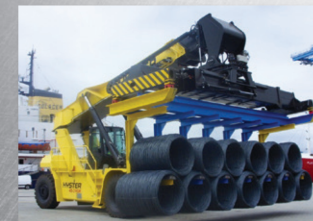
Wózek typu ReachStacker z narzędziem do transportu wielu zwojów – do zwojów skrętek drucianych
