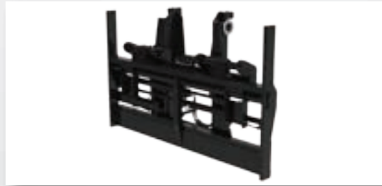
Karetką przesuwu bocznego typu pin z ramą fartuchową i pozycjonerem widel o szerokości 2350 mm – niezależne i równoczesne sterowanie widłami
