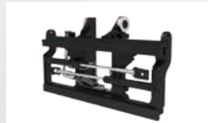
Karetka dwufunkcyjna typu hakowego z przesuwarem bocznym i pozycjonerem widel (PW mogą być niezależne lub jednocześnie działające) o szerokości 2,540 mm
